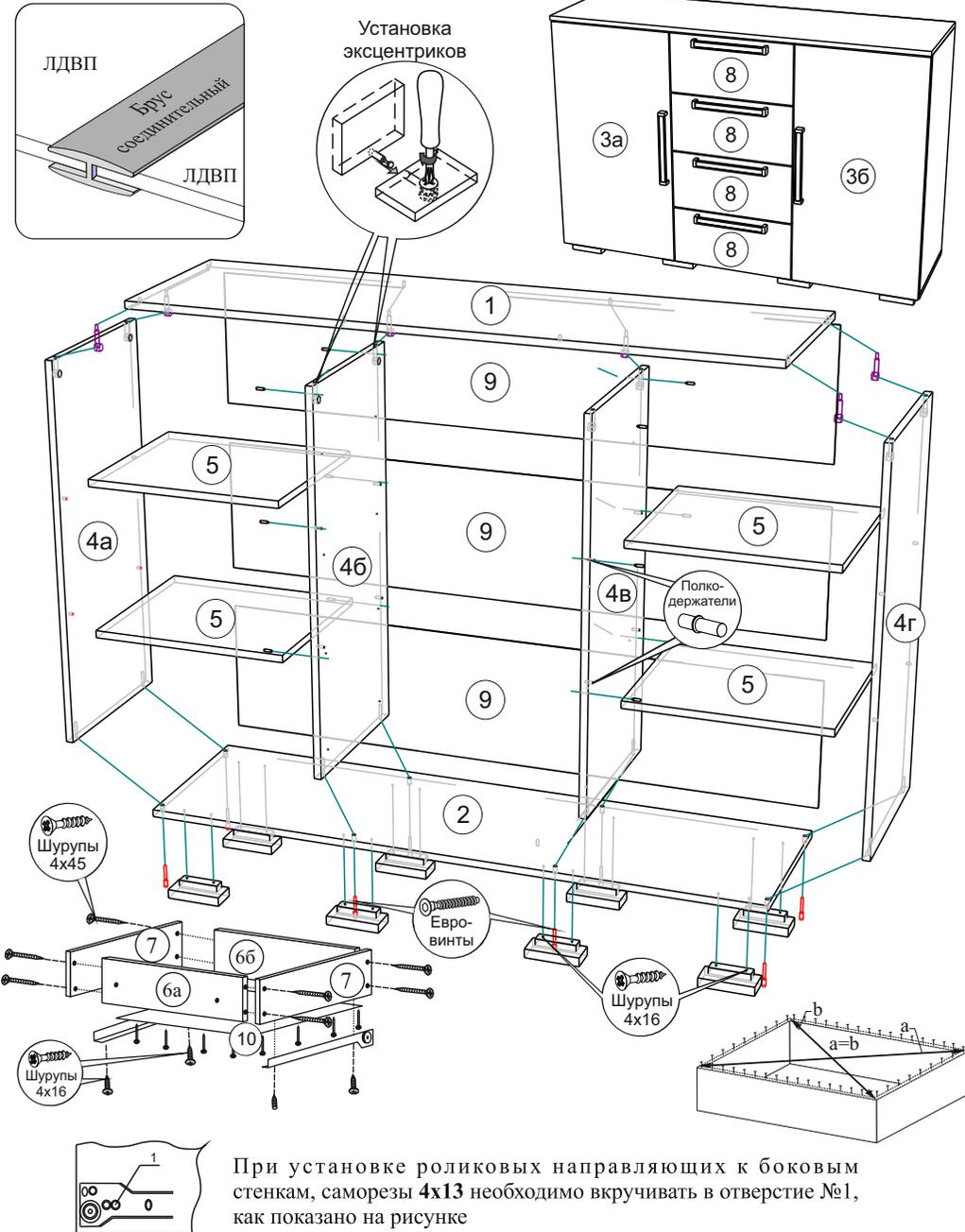
При установке роликовых направляющих к боковым стенкам, саморезы 4x13 необходимо вкручивать в отверстие №1, как показано на рисунке
