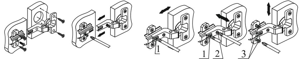
Петли позволяют регулировать положение створок относительно корпуса изделия. Если нижняя часть створки отстает, нужно ослабить винт 1 и сдвинуть створку, а затем затянуть винт 1. Если створка наклонена, нужно выправить наклон створки винтом 2, а затем затянуть винт 1. По высоте створки регулируются с помощью шурупов 3.
