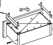
Для правильного открывания ящиков, необходимо выровнять диагонали каркаса ящика ( $a=b$ ) и только потом прибить ЛДВП не нарушая диагонали.
